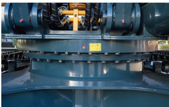
锻造式回转支撑圈，耐久稳定
