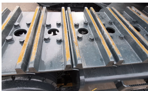
2齿履带板，矿山作业更稳定
