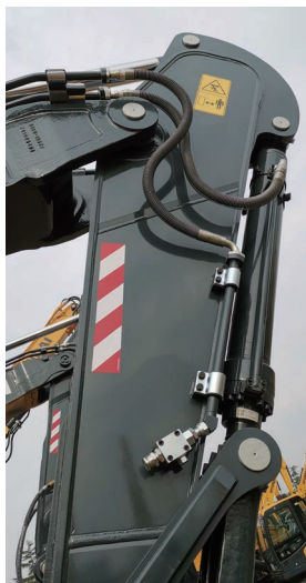
选配破碎管路，与现代破碎机配合使用稳定高效
