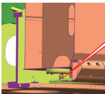
变更前（R485LVS）： 放油阀安装在油箱底部
